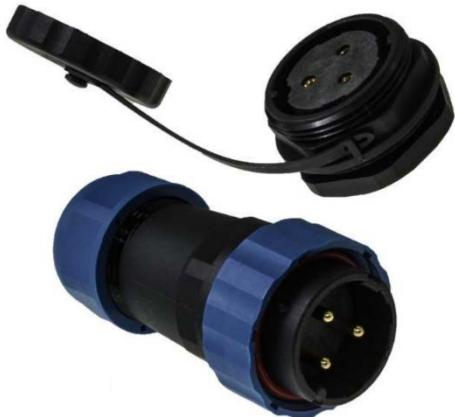
Герметичный разъем (комплект) с заглушкой SZC28 3P-M-FB, вилка-розетка, 3 контакта, диаметр входящего кабеля 15 мм, IP68, 45 А, 250 В, является пылезащищенным и влагозащищенным. Герметичный разъем соответствует высокой степени защиты, что гарантирует работу разъемов при длительном погружении в воду (более 30 минут) на глубину больше 1 м.
