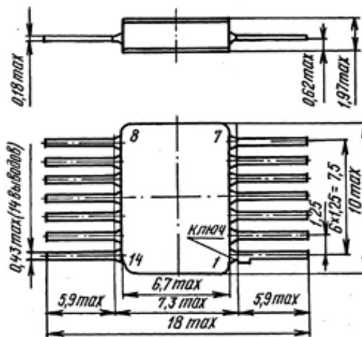
Рисунок 1. Габаритные чертежи корпусов 401.14-4 и 401.14-5М
