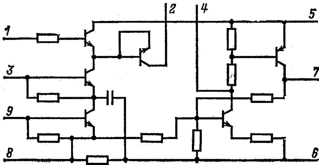
Назначение выводов: 1 — вход кадрового синхроимпульса; 2 — выход 1 схемы совпадения; 3 — вход цветоразностного сигнала В-У; 4 — вход 1 триггера; 5 — напряжение питания ( $U_{п}$ ); 6 — общий; 7 — выход; 8 — выход 2 схемы совпадения; 9 — вход цветоразностного сигнала R-У.
