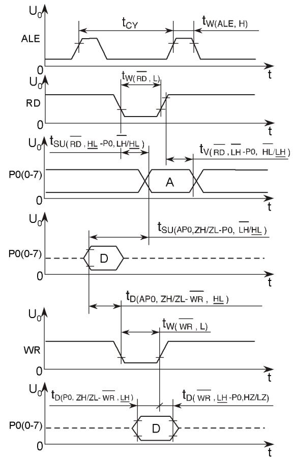
**ДИАГРАММА СОСТОЯНИЙ В РЕЖИМЕ РАБОТЫ С ДОПОЛНИТЕЛЬНЫМ ПОРТОМ С ПОМОЩЬЮ ПОРТА P2**
