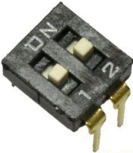
DIP-переключатель RUICHI DS2-02, 25 мА, 24 В, 50 мОм, 2 (ON-OFF) с шагом 2,54 мм — это такой элемент управления, который можно встретить на многих старых платах компьютеров. Этот элемент управления представляет собой группу из нескольких переключателей, заключенную в корпус DIP (dual in-line package). Термин DIP-переключатель (DIP Switch) может относиться как ко всей группе в корпусе ДИП, так и к отдельному переключателю из этой группы.
